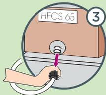
Retire el conector y coloque una nueva BIB con edulcorante HFCS.
