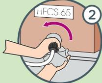
Use un trapo para atrapar cualquier derrame, y gire el conector en sentido contrario al reloj para aflojarlo.
