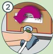
Use un trapo para atrapar cualquier derrame, y gire el conector en sentido contrario al reloj para aflojarlo.
