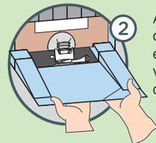
2 Abaissez la porte avant du compartiment d'édulcorant artificiel et désenclenchez le levier de verrouillage (le levier se déplace de droite à gauche).
