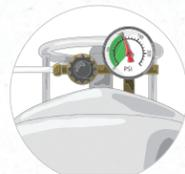
Remplacez ou remplissez la bouteille de CO2 si la pression est inférieure à 105 psi.
