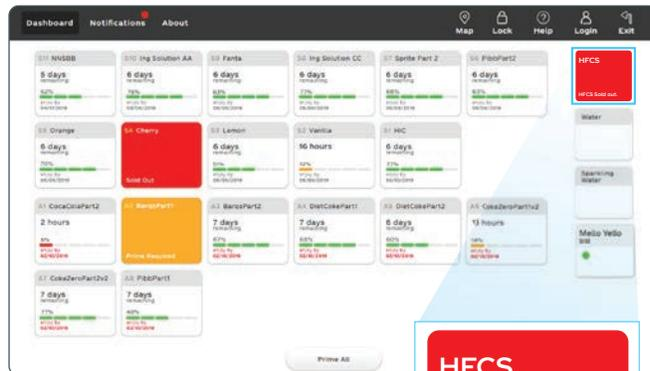
Lorsque le sac en boîte de sirop de maïs à teneur élevée en fructose est vide, vous devez le remplacer et réinitialiser le module en suivant les étapes suivantes :
