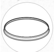
Retire e inspeccione la junta de la tolva
