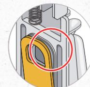
Retire e inspeccione la junta del grifo
